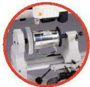
Con las mismas características que la IS200 estándar pero con una base TX que le permite grabar objetos cilíndricos así como placas mas grandes ya que su prensa para sujetar objetos tiene movimientos de desplazamiento a la derecha, izquierda, enfrente, atrás, arriba y abajo. Una buena elección para las platerías y joyerías.
